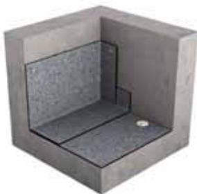
3. Skjær til, brett og sveis fast kappen, samt spikre i overkant.
